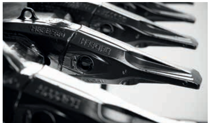
I denti GET di Hitachi comprendono denti autoaffilanti e adattatori affidabili, per garantire un montaggio preciso.
