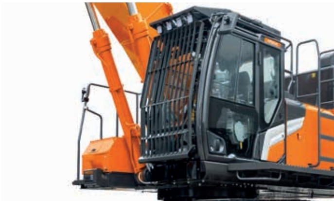
La protezione anteriore, la protezione del tetto e quattro fari montati sulla cabina sono standard su ZX530LCH-7.
