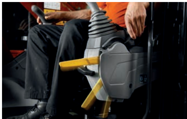
La leva di esclusione circuito di pilotaggio aumenta la sicurezza in cabina.
