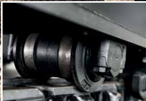
I materiali rinforzati delle boccole aumentano la resistenza all'usura.
