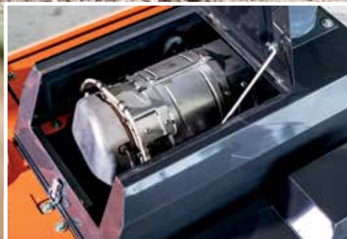
Il sistema SCR riduce le emissioni e i livelli di rumorosità.
