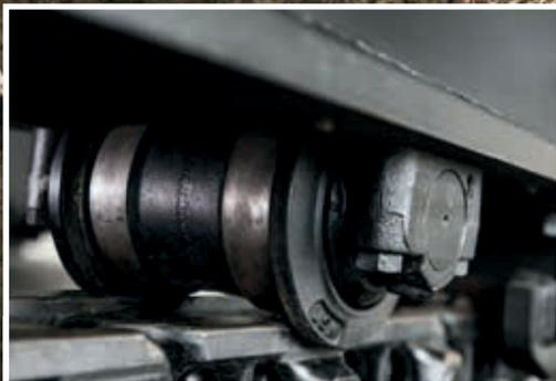
Il nuovo disegno del rullo inferiore evita i danni causati dall'intrusione di fango.
