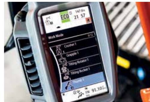
Due modalità di inclinazione e rotazione benna aumentano la versatilità del modello ZX190W-6.
