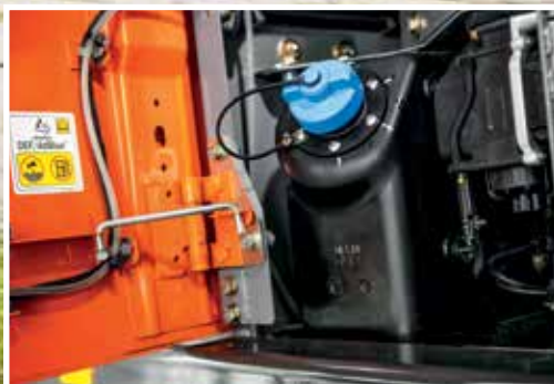
L'urea è introdotta nei gas di scarico per ridurre le emissioni.
